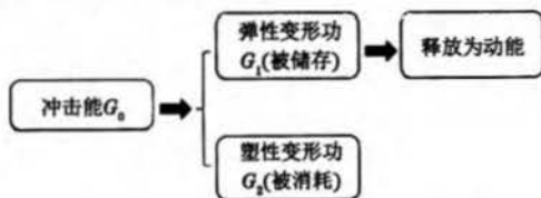
图3 里氏硬度检测中能量的转换
